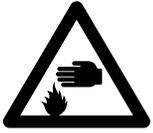
5.- Las altas temperaturas y movimiento de partes están bajo el sudario. Para prevenir quemaduras u otras heridas no opere con el sudario removido. Permitir que las partes del compresor se enfríen antes de manipular o hacer mantenimiento.
