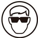
7.- Utilice siempre gafas de seguridad o lentes cuando use el compresor de aire. Nunca apunte ninguna boquilla o pulverizador hacia una persona o cualquier parte del cuerpo.
